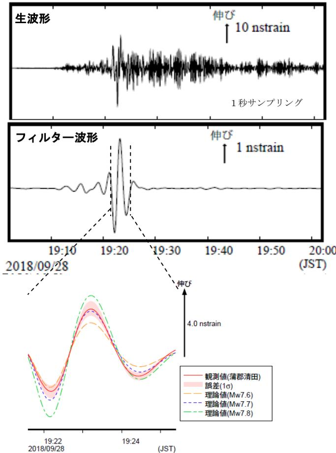
気象庁が東海地域に設置している埋込式体積ひずみ計で観測された今回の地震の波形と理論波形の振幅比較により、地震のモーメントマグニチュード (Mw) の推定を行った。
