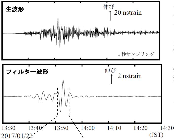
気象庁が東海地域に設置している埋込式体積ひずみ計で観測された今回の地震の波形と理論波形の振幅比較により、地震のモーメントマグニチュード (Mw) の推定を行った。
