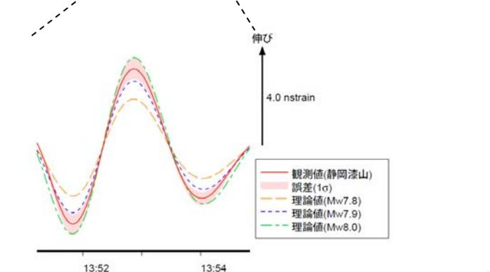
静岡漆山観測点の観測波形と理論波形の振幅比較 (上図)
