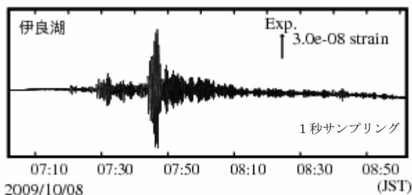
気象庁が東海地域に設置している埋込式体積歪計の今回の地震による波形記録と理論波形の振幅比較により、地震のモーメントマグニチュード (Mw) の推定を行った。
