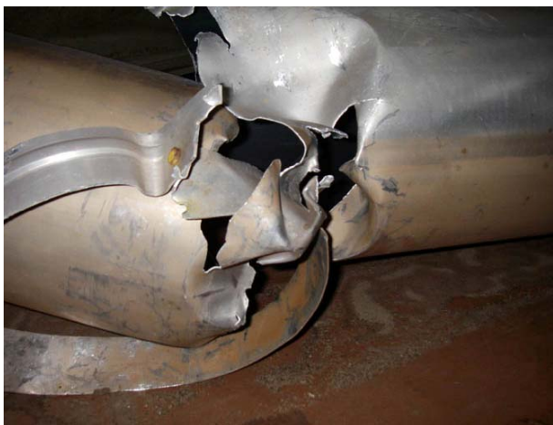
破断したフロートチューブ1
