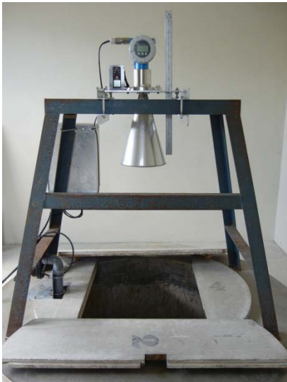
観測機器の更新(電波式検潮儀)
