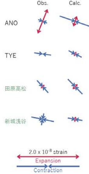
図8 2019/06/29-30の歪・傾斜・地下水変化（図5[C]）を説明する断層モデル。
