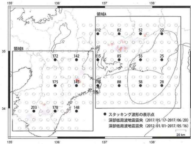
スタッキング波形は、上図の各監視点について、宮岡・横田(2012)の手法により、気象庁、静岡県、国立研究開発法人産業技術総合研究所のひずみ計データを基に作成している。
