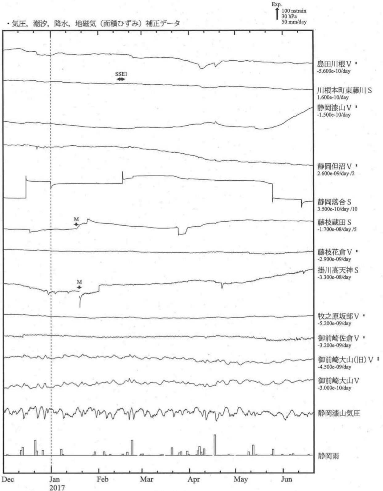
※掛川高天神、藤枝蔵田、静岡落合は、降水に伴うひずみ変化を補正していない。
