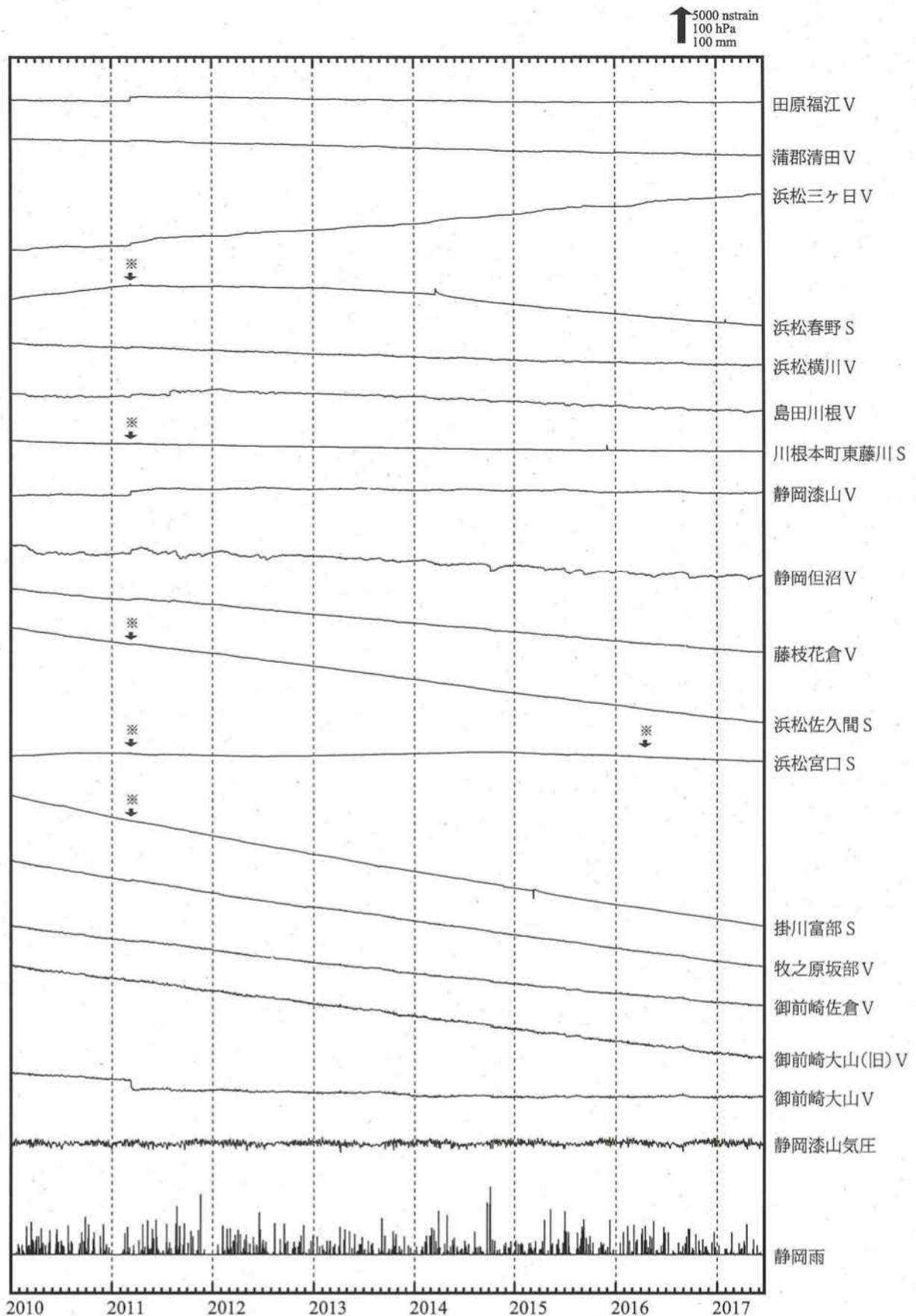
※面積ひずみは、東北地方太平洋沖地震および熊本地震に伴うステップ状の変化を除去して計算している。
