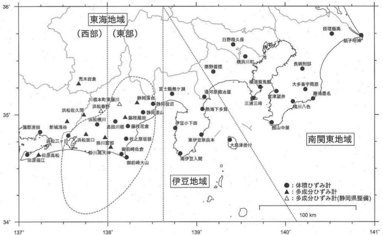
※観測点名の記号Vは体積ひずみを、Sは多成分ひずみ計で観測した線ひずみより計算した面積ひずみを示す。
