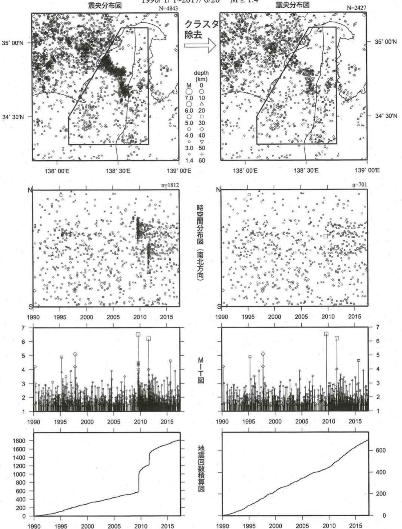
2010年頃から2015年末頃まで、地震活動指数はやや高い状態で推移しており、クラスタ除去後の地震回数積算図(右下図)からも同様の傾向が見られる。これは、2009年8月の駿河湾の地震(M6.5)と、2011年8月の駿河湾の地震(M6.2)余震活動が適切にデクラスタされていないためである。
