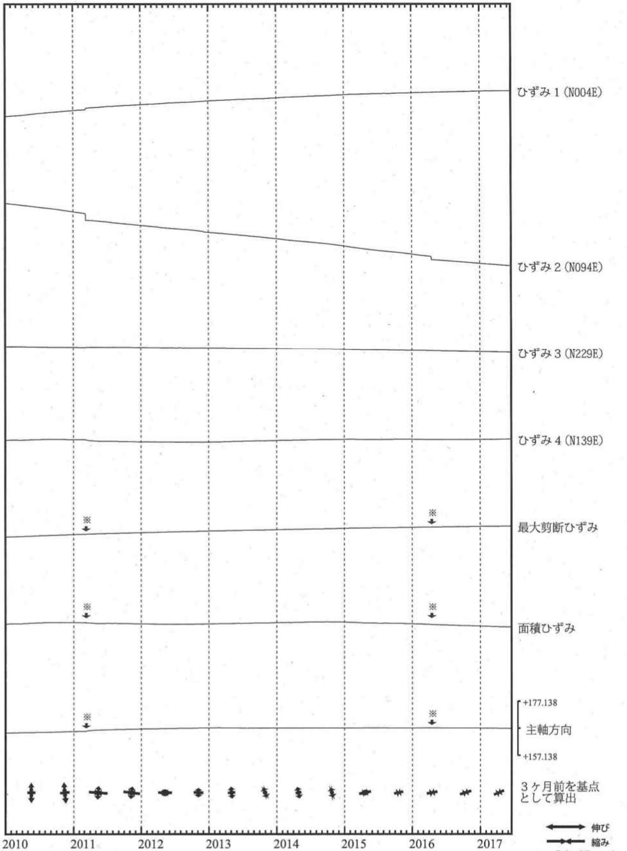
※最大剪断ひずみ、面積ひずみおよび主軸方向は、東北地方太平洋沖地震および熊本地震に伴うステップ状の変化を除去して計算している。
