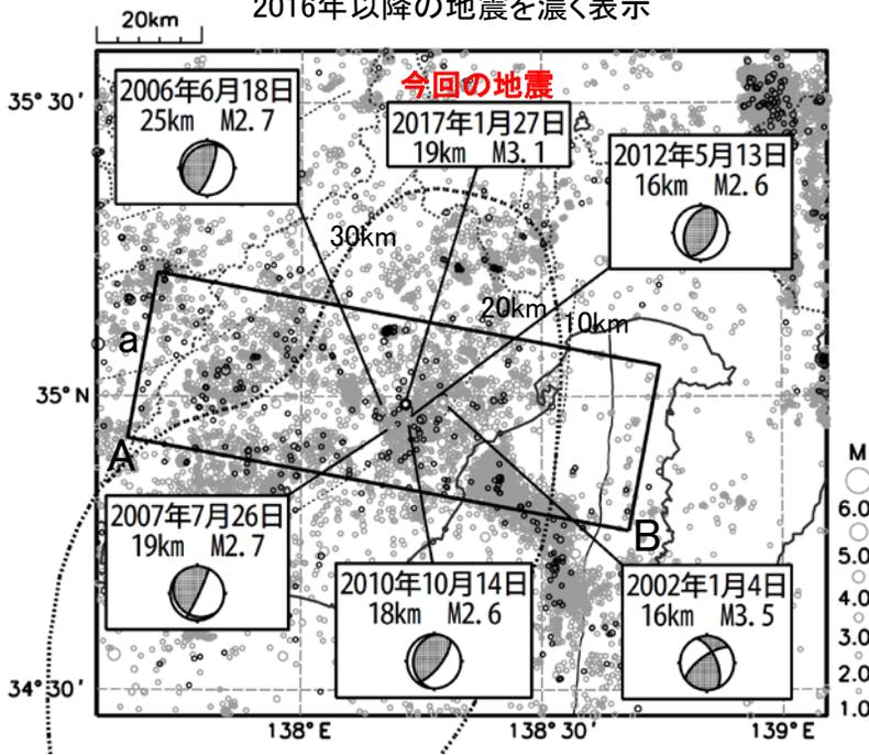
震央分布図中の点線のコンターは、Hirose et al. (2008) によるプレート境界を示す。
