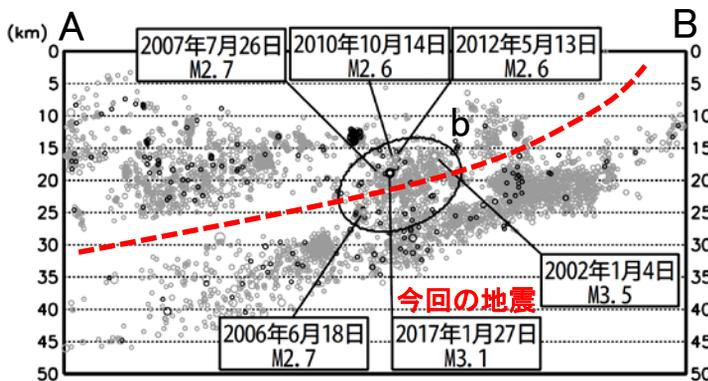
断面図中の赤色の点線はHirose et al. (2008) によるプレート境界の位置を示す。
