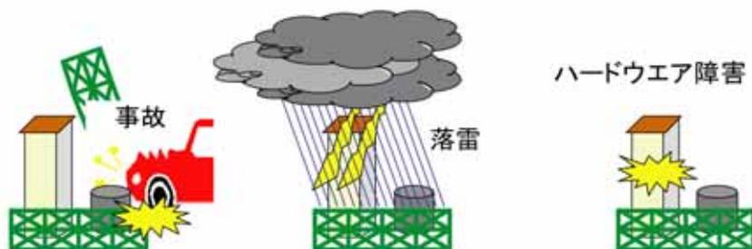
地震計への何らかの強い振動入力や機器故障により誤報を発信する可能性がある。この場合10数秒後にキャンセル報を発信する
