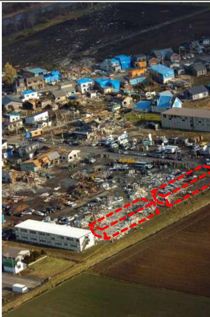
DOD=3 2階建て以上(2連以上)の転倒 手前の飛ばされていない仮設事務所と同じものが2棟(赤点線)飛ばされた。右図は飛ばされた仮設事務所の杭基礎の状況で、杭が引き抜けに対して抵抗した痕跡はない。 (2層以上の連棟で短辺長さが10m未満であるので代表値を採用する事例) 写真提供：(左) 東京工芸大学風工学研究センター、(右) 国立研究開発法人建築研究所
