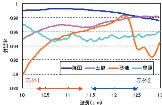
図4 主な地表面の種類についての赤外波長帯における代表的な射出率 (MODIS emissivity libraryによる)
