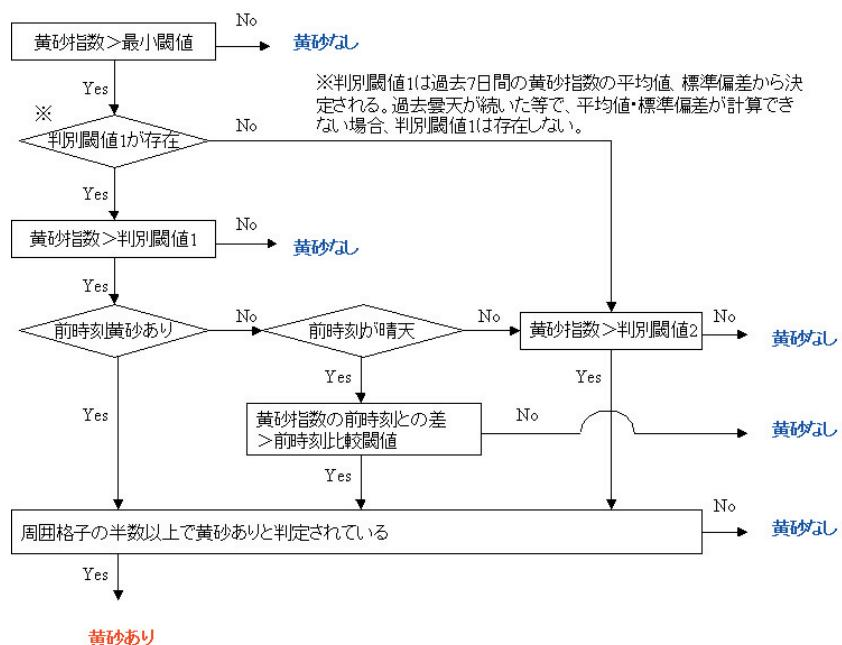
図8 黄砂判定の流れ図
