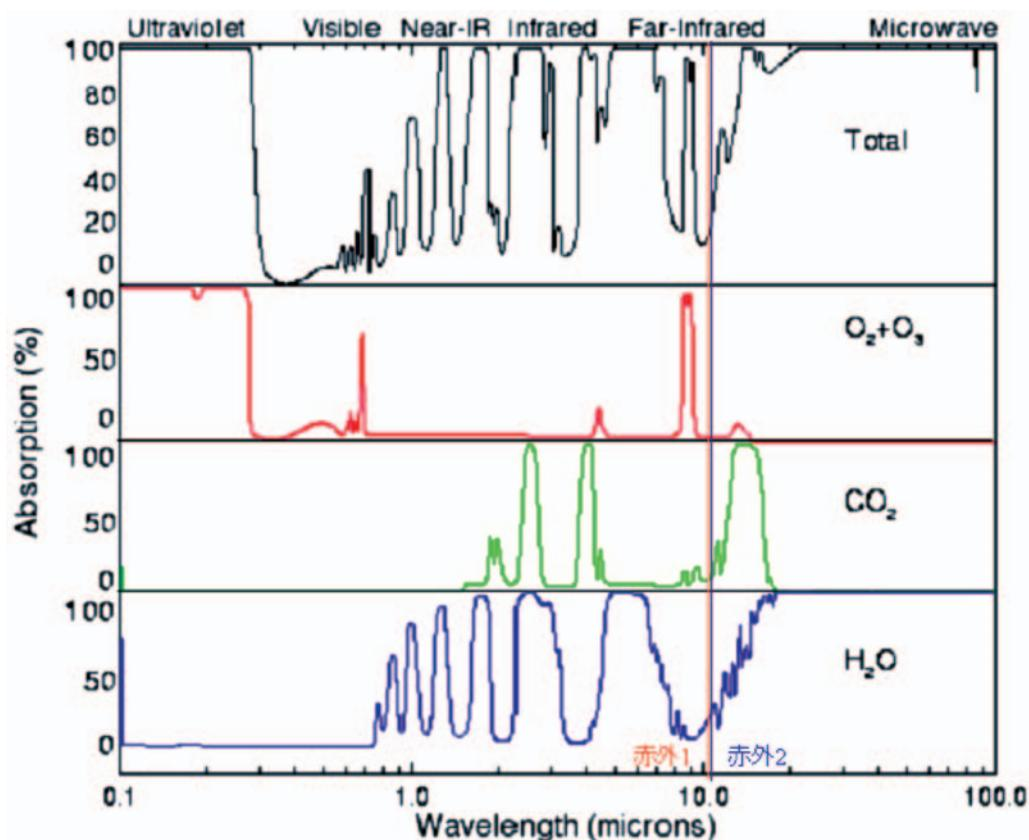
図1 各大気成分の波長別吸収率 (Peixoto, J.P. and Oort, A.H., 1992)
