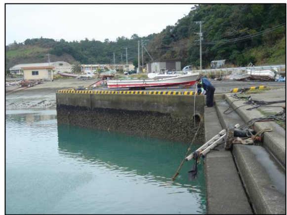
27日調査時の測量の様子 （25日に撮影した左の写真を参考に、当時の下がりがきつた潮位を測量している）
