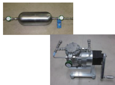
図トピックス1-5 大気試料採取に用いる金属製容器（左）と手動ポンプ（右）
